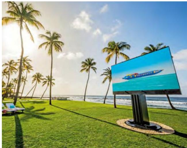
**OUTDOOR.** Draußen fernsehen wird mit dem „C Seed 201“ aufs nächste Level gehievt. Fünf Meter hat die Bildschirmdiagonale des faltbaren LED-Screens. Bei Schlechtwetter oder zu starkem Wind klappt sich das Gerät von selbst ein und versenkt sich in der Säule. Es gibt auch kleinere Varianten davon, z. B. für Yachten.
