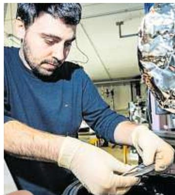
Aktivkohlegewebe wird speziell behandelt, damit es mehr Wasserstoff aufnehmen kann
