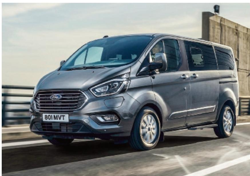
**Ford hat dem Tourneo einen seriellen Hybrid spendiert. Das heißt, der Verbrennungsmotor, ein Dreizylinder, dient also ausschließlich dazu, Strom für die Akkus zu erzeugen, gefahren wird immer mit dem E-Antrieb**
